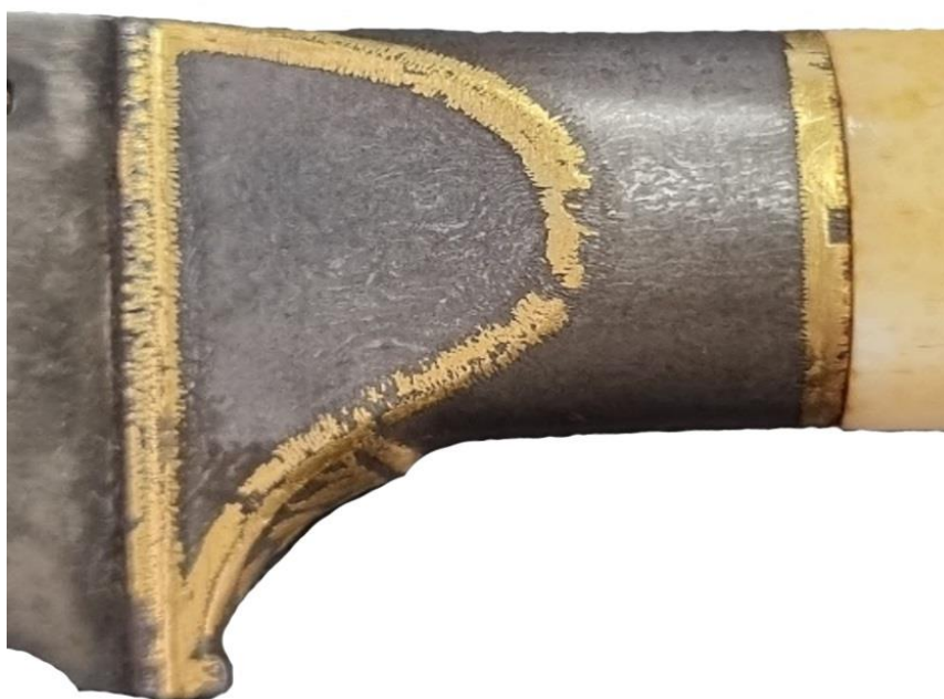
Илл. 83. Кард. Иран, XVIII век. Рисунок булата на больстере. Коллекция Д. А. Суханова.
