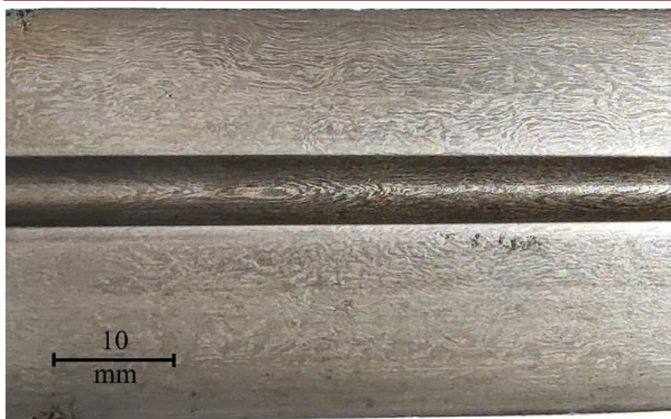
Илл. 43. Кинжал (кама). Закавказье, XVIII-XIX вв. Макроструктура клинка. Коллекция К. С. Хайдакова.
